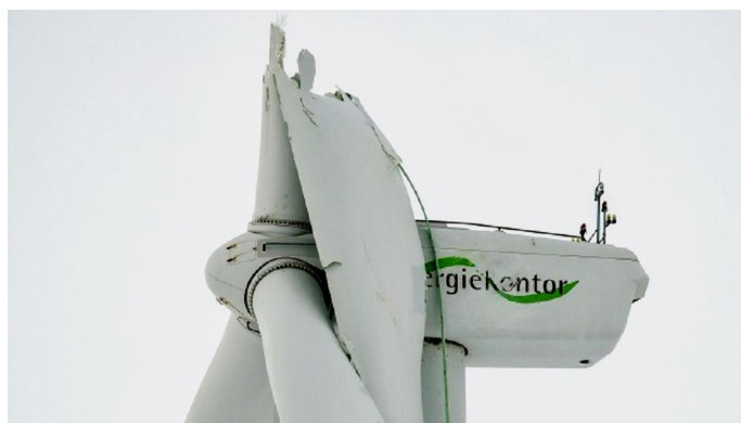
Ein Windrad mit einem gebrochenen Rotorflügel (dpa / Patrick Pleul)
