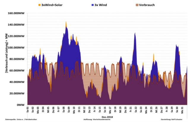
Bei der fiktiv angenommenen dreifachen Leistung der Wind- und Solaranlagen ist bereits abzusehen, dass der überschüssig erzeugte Strom in immer größer werdenden Mengen abgeregelt werden muss, um die Versorgung stabil zu halten.
