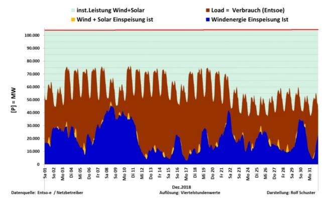
Windstromanteil (blau) 34,53 %, Solarstromanteil (gelb) 1,23 %, gesamt 35,76 % der Netzlast. Die Residuallast (braune Fläche) von 64,24 % muss durch konventionelle Kraftwerke erbracht werden
