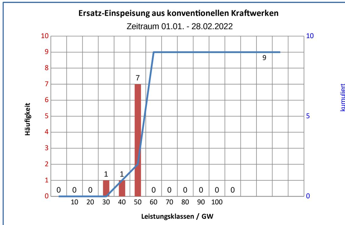
Statistisches Ergebnis von Jahresbeginn bis zum 28. Februar 2022. An 9 Tagen trat Windleistung unter 5 GW (= 8% der installierten Leistung) auf. Der jeweils am Minimum eines Schwachwindtages ermittelte Leistungsbedarf abzüglich Windstromeinspeisung und abzüglich aller sonstigen EE-Einspeisungen ergibt die geforderte Ersatzkapazität, aktuell zwischen > 20 bis ≤ 50 GW.
