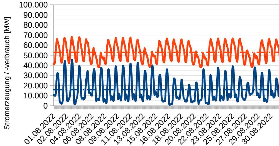
**Diagramm 1:** Verläufe von Stromerzeugung aus Wind + PV und Stromverbrauch bei aktuellem Ausbaustatus August 2022
