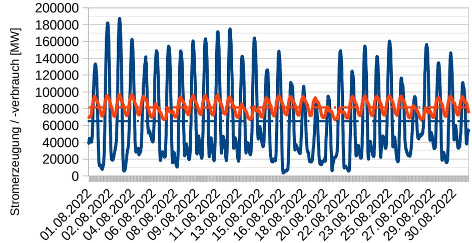
**Diagramm 2:** Verläufe von Stromerzeugung aus Wind + PV und Stromverbrauch, hochgerechnet aus August 22 entspr. Planungsziel BMWK für August 2030
