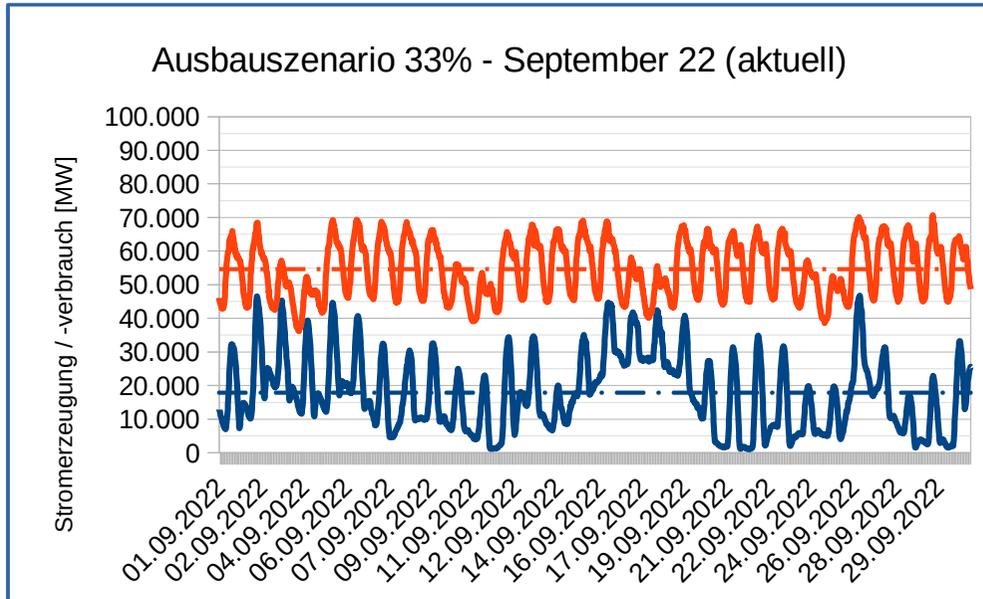
**Diagramm 1:** Verläufe von Stromerzeugung aus Wind + PV und Stromverbrauch bei aktuellem Ausbaustatus August 2022
