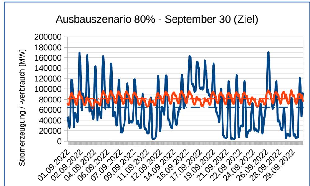
**Diagramm 2:** Verläufe von Stromerzeugung aus Wind + PV und Stromverbrauch, hochgerechnet aus September 22 entspr. Planungsziel BMWK für September 2030
