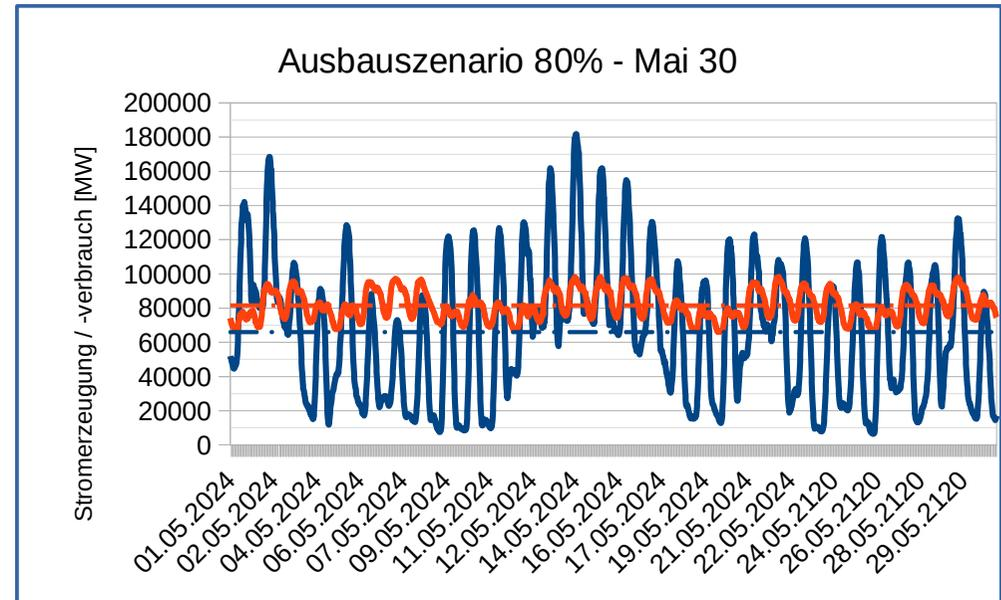
**Diagramm 2:** Verläufe von Ökostromerzeugung (Wind, PV, Biomasse und Wasserkraft), hochgerechnet aus Mai 2024 entspr. Planungsziel BMWK für Mai 2030
