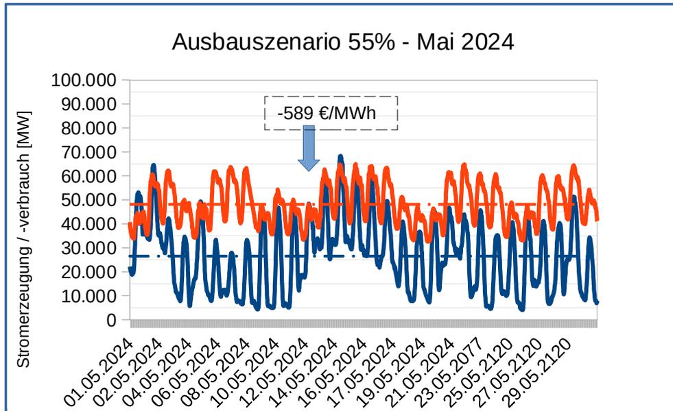
**Diagramm 1:** Verläufe von Ökostromerzeugung (Wind, PV, Biomasse und Wasserkraft) und Stromverbrauch bei aktuellem Ausbaustatus Mai 2024
